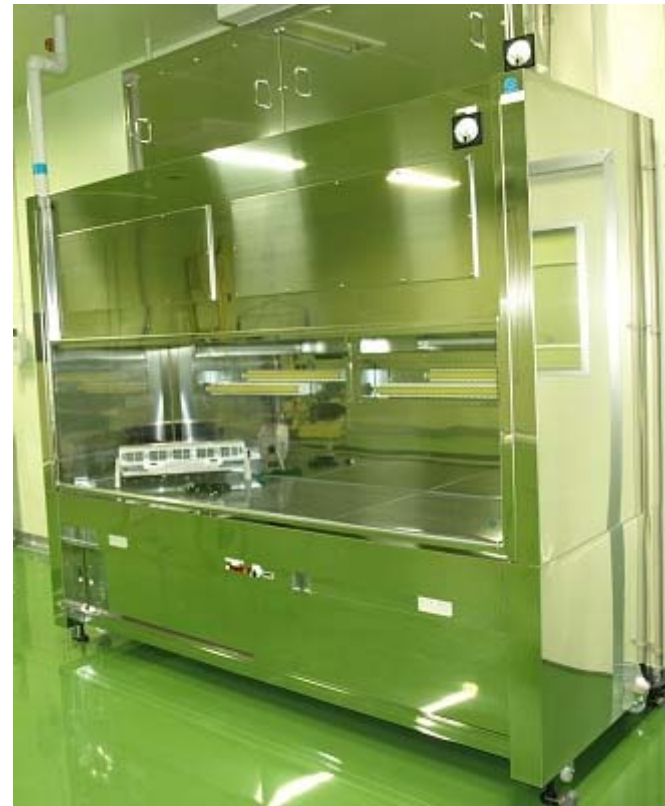
クリーンドラフト クラス100
